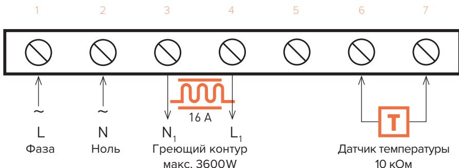
Подключите систему теплого пола к терморегулятору CLIMATIQ BT; РТ после полного высыхания плиточного клея в соответствии с рекомендациями производителя. Начертите схематично места установки кабеля, воспользовавшись приложением на стр.13 и зарегистрируйте систему. Процесс регистрации описан в Гарантийном талоне на стр. 14.
